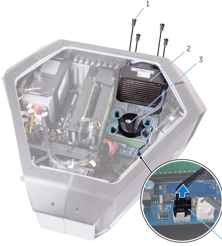
شكل 45. إزالة مجموعة تبريد المعالج بالسوائل
