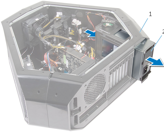
شكل 51. إزالة وحدة الإمداد بالتيار
