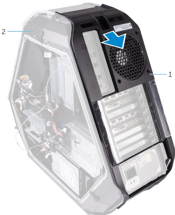
شكل 71. إزالة إطار التثبيت الخلفي
