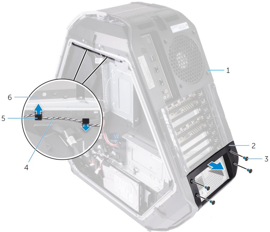
شكل 68. إزالة كابل نظام الإضاءة الذي يدعم قابلية الوصول إلى وحدة الإدخال/الإخراج (I/O) الخلفية
